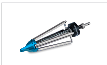
Elnr. 8854666-70 Rørkalibratorer / inspeksjonssonder, måler nedgravde rør ø 30-135 mm. Modell: XCATU9500 ++
