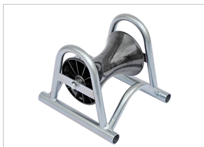
Elnr. 8854649 Kabelrulle på bakken, nylonrulle, velegnet for maks ø 160 mm kabel. Modell: JZKVR171KUH
