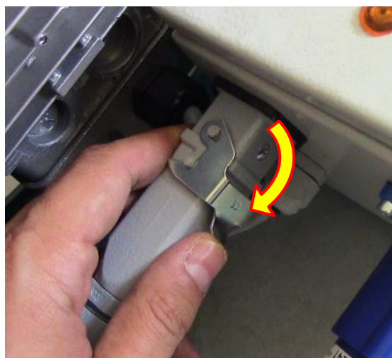
Fig. 22b – Lås tilkoblingen til fotpedalkontrollen
