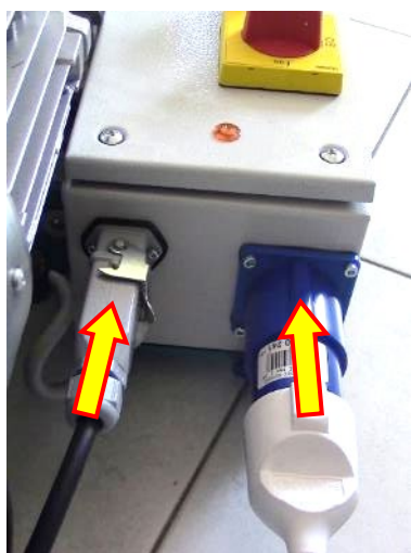
Fig. 22a – Tilkobling til strømforsyningen
