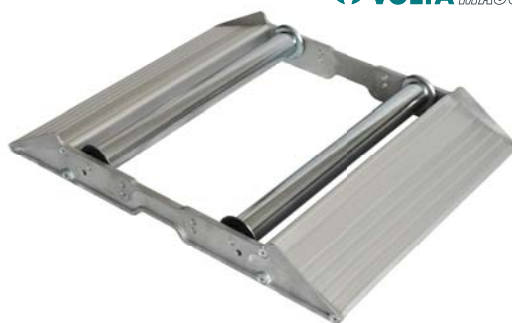
Elnr. 8854664-65 Trommelstativ produsert i aluminium. For tromler ø 200-700 mm. Designet for enkel innlasting av trommel, ruller i galvanisert stål og kulelager, passer til tre forskjellige trommelstørrelser. Antiskli-design. Modell: MPSA200NE / MPSA250NE
